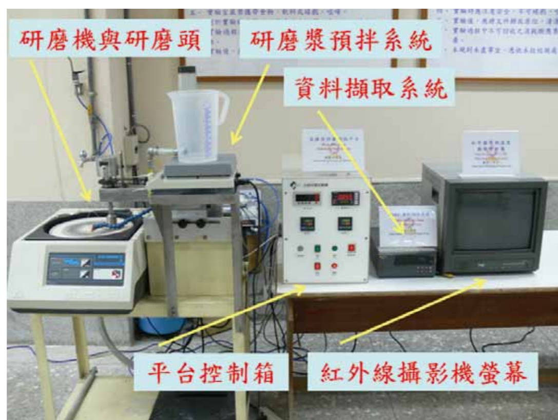
軟墊研磨測試平台架構
