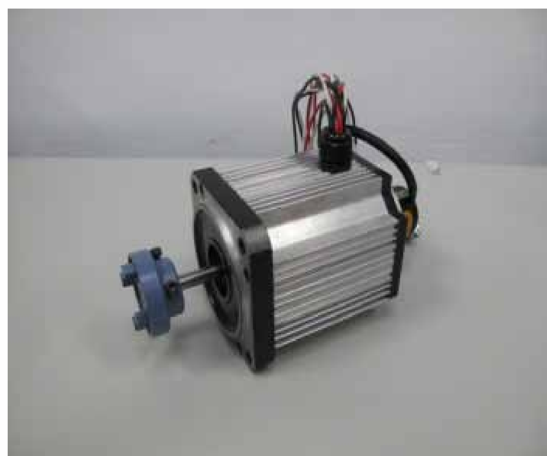
(圖一) 三相 6/4 極 PMA-SynRM 馬達實體圖
