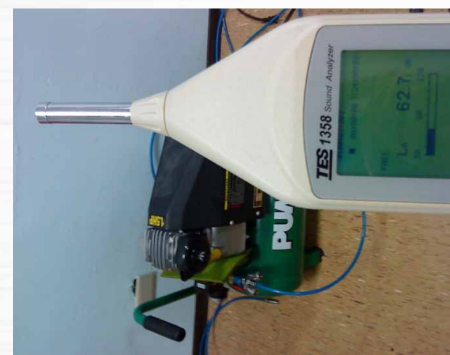
(圖 2) 多功能噪音計之空壓機房噪音偵測
