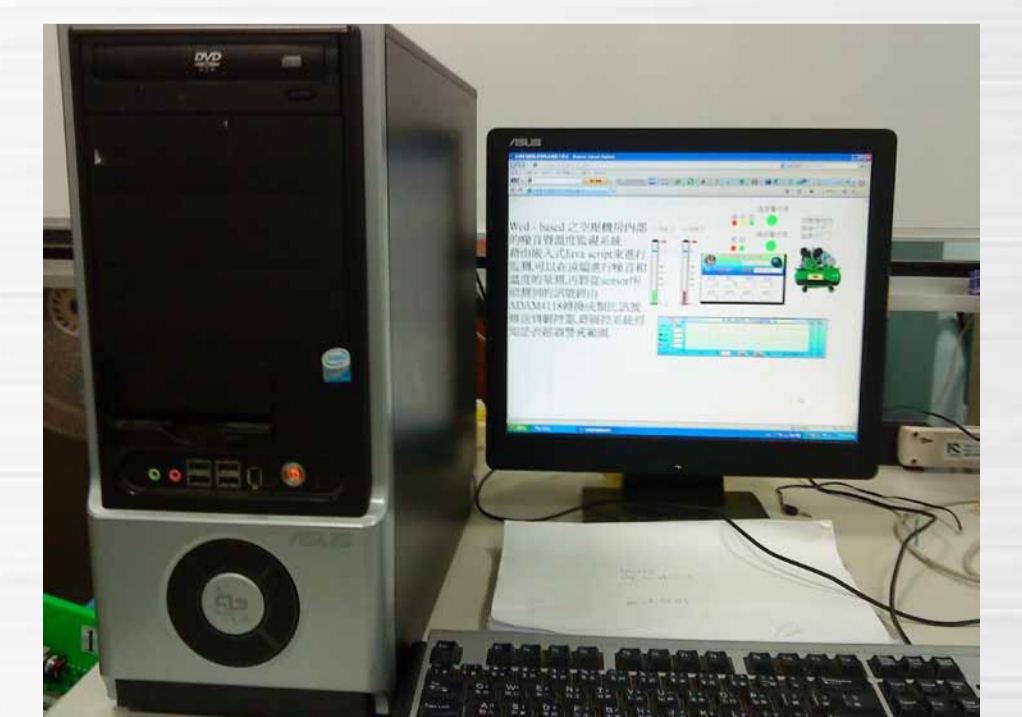
(圖 10) Web-Based 之噪音暨溫度監視系統之實體遠端 PC 監控畫面
