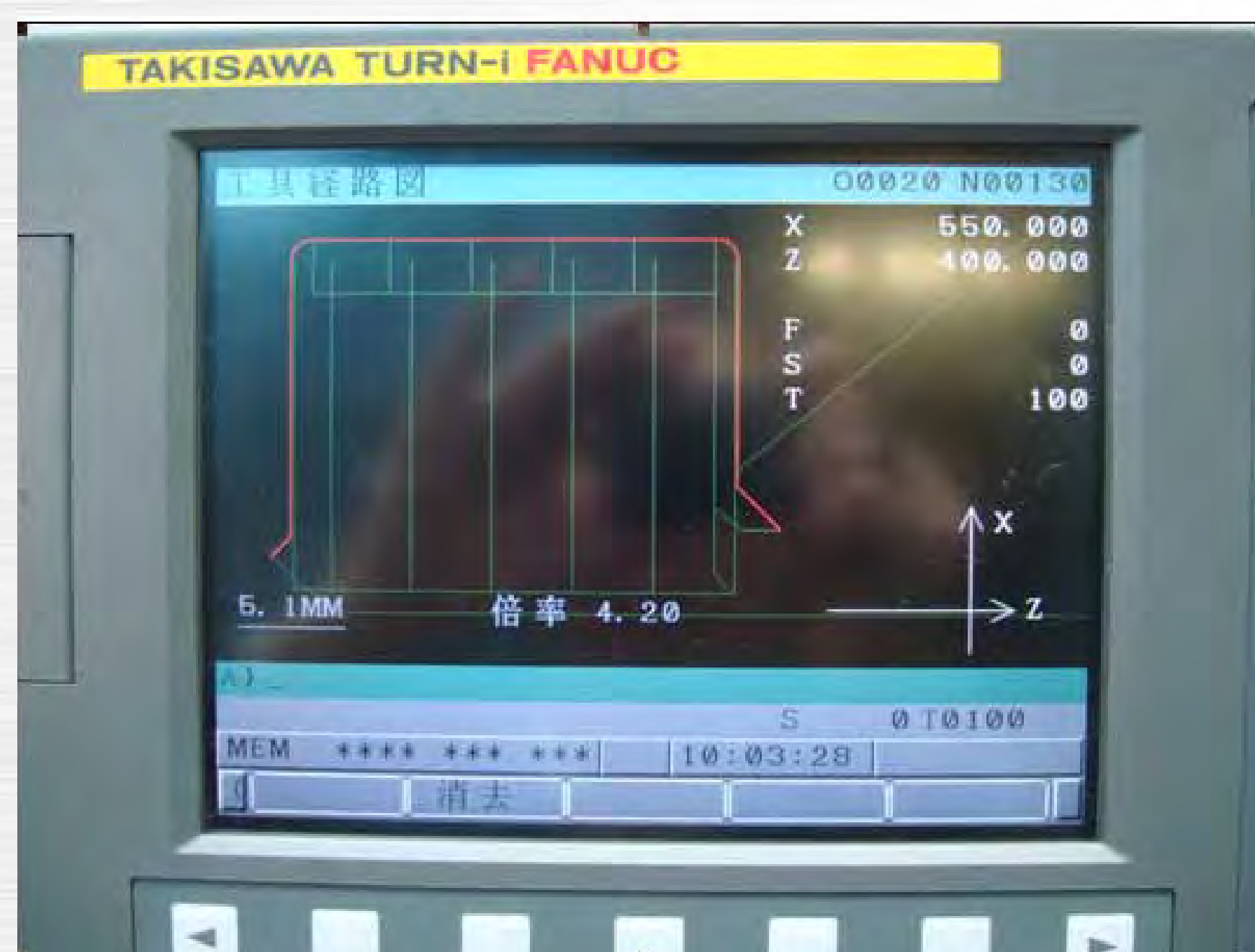
(圖 1) 複合型內外槽切削路徑規劃 (COIGPP) 循環於 CNC 車床控制器模擬路徑示意圖
