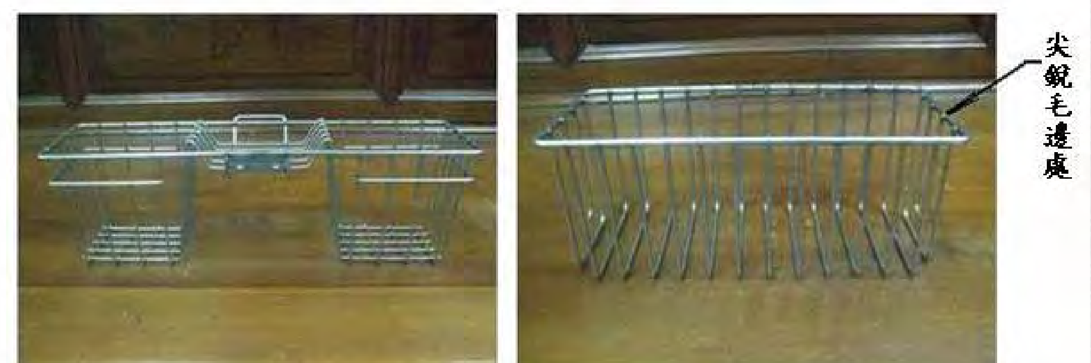
(圖 3) 金屬線材與傳統框架點焊成型製程
