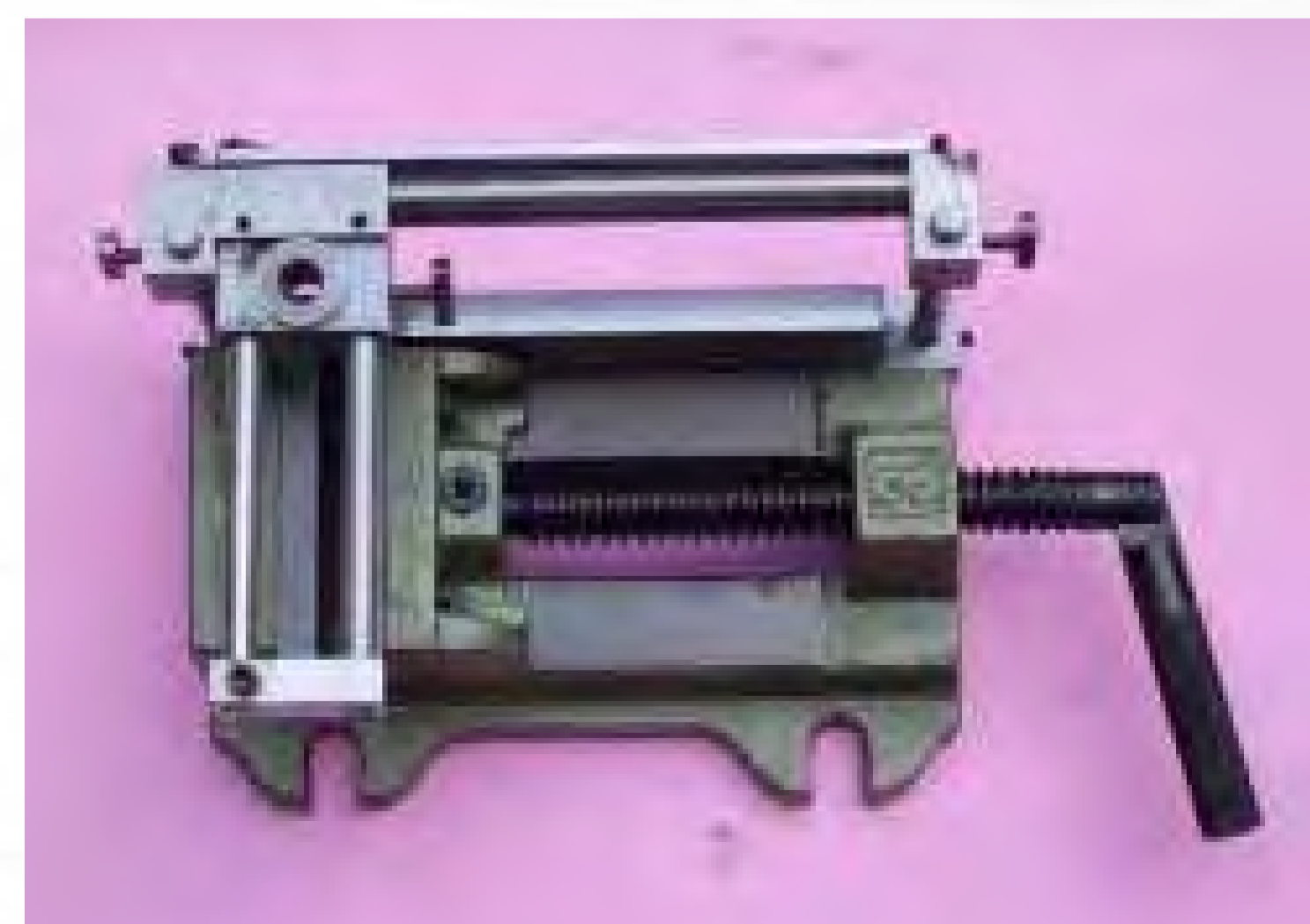
鑽孔免劃線之虎鉗夾具示意圖
