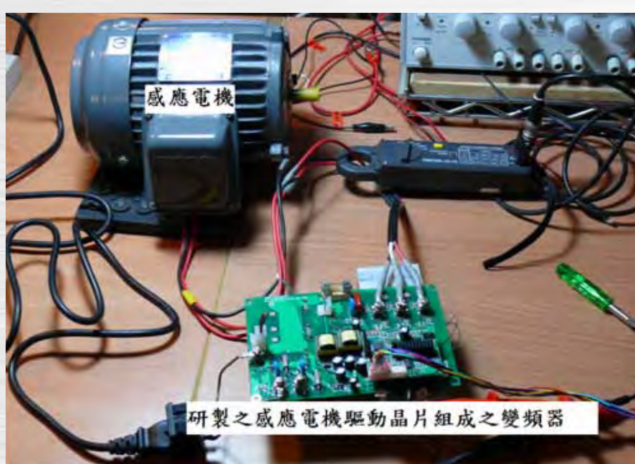
(圖 4)研製之感應電機驅動晶片組成之變頻器驅動應用系統
