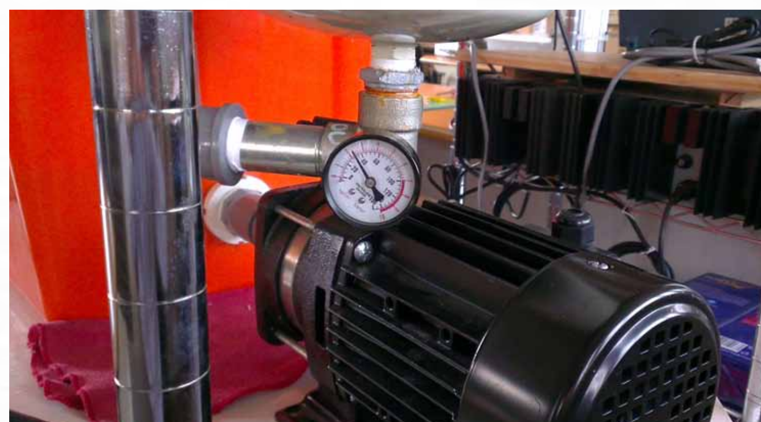
(圖 4) 測試系統於運轉中之恒壓控制紀錄照片
