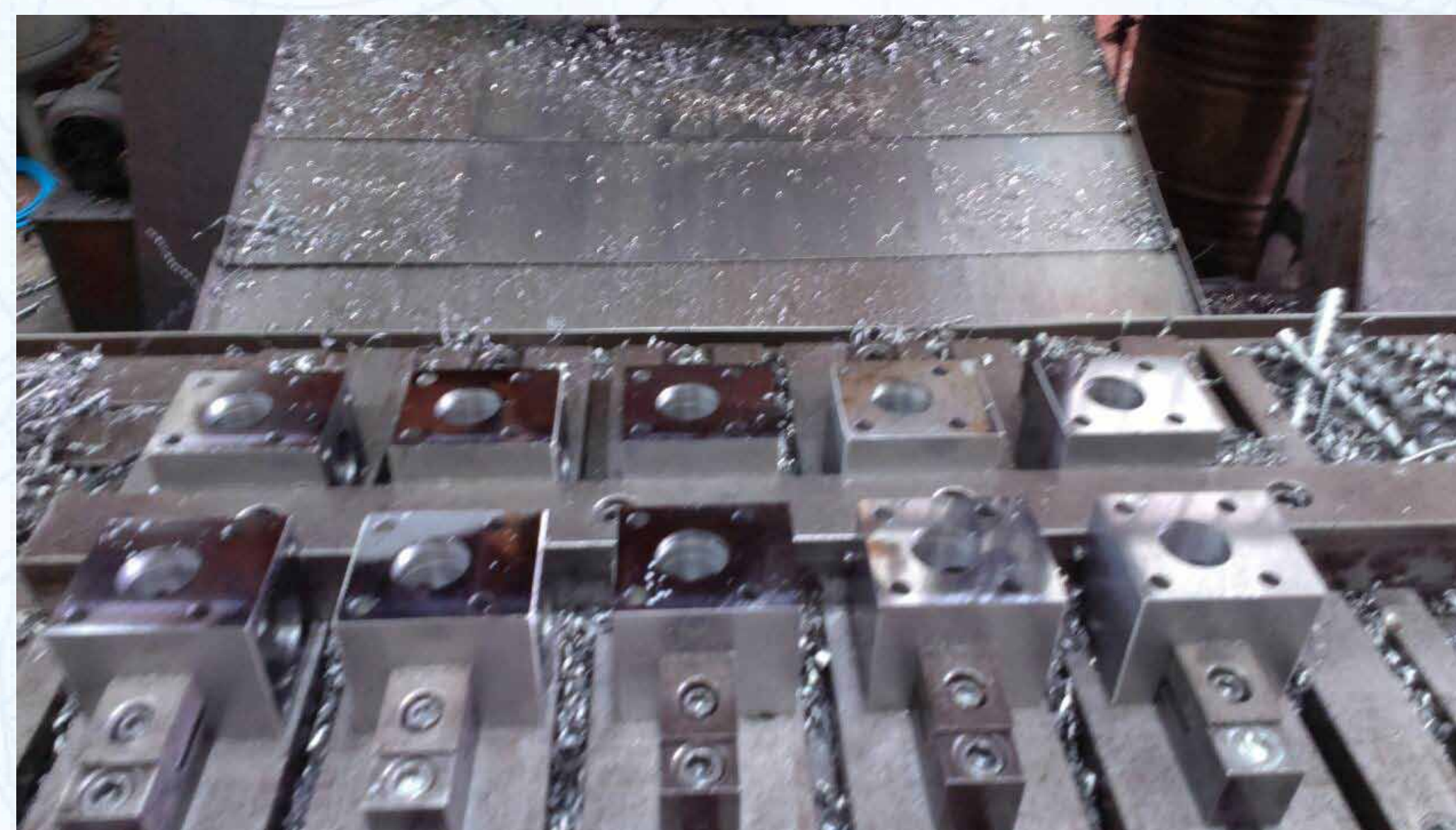
(圖 2) SHFDPP 鑽削路徑規劃循環加工完成圖
