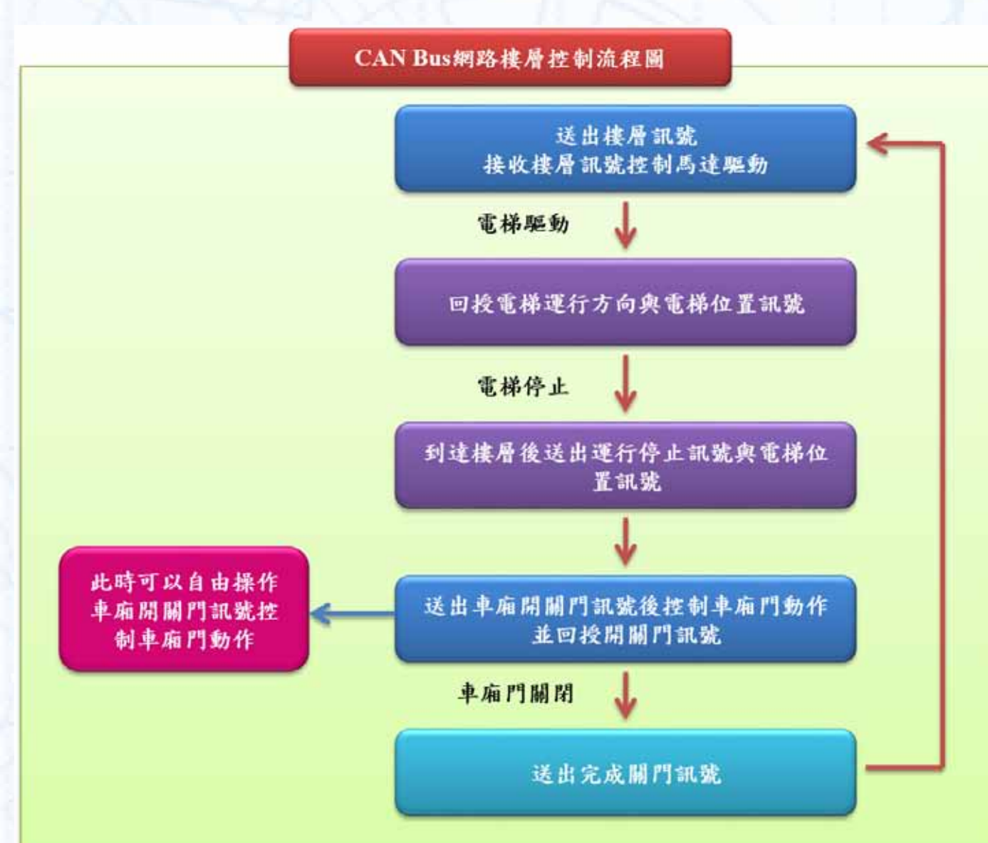
(圖 3) CAN Bus 控制流程圖
