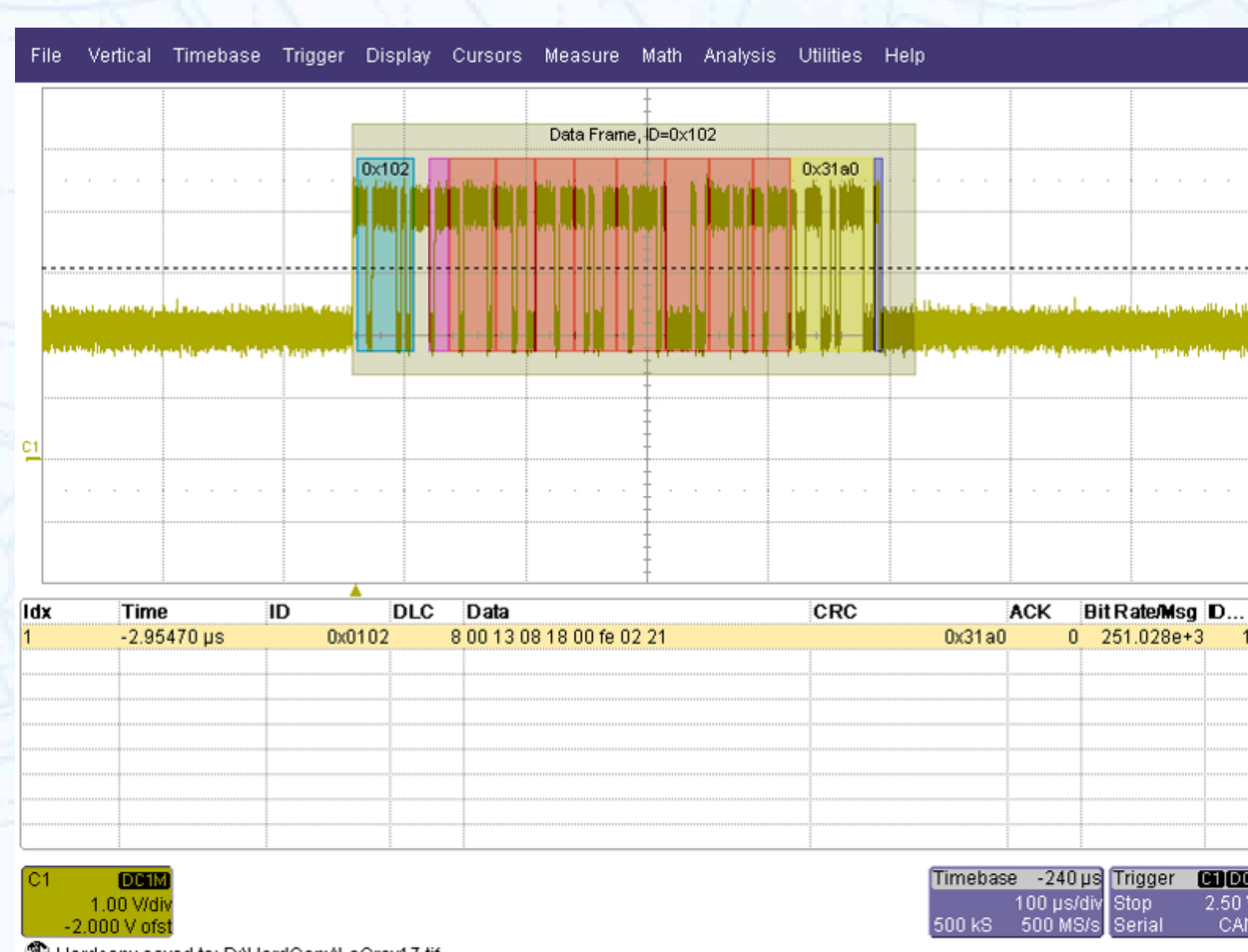
(圖 4) CAN Bus 實測波形圖
