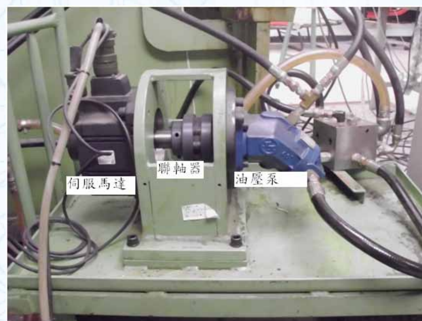
(圖 2) 泵控折床的一組伺服驅動子系統
