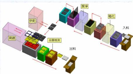
〔圖 1〕真空鍍膜制程技術，包含糙化、潔淨、烘乾、濺鍍與品管等，由於程式相當複雜，公司長久以來均採用人工進行移載、裝卸與品管等動作，形成龐大的人事成本壓力。
