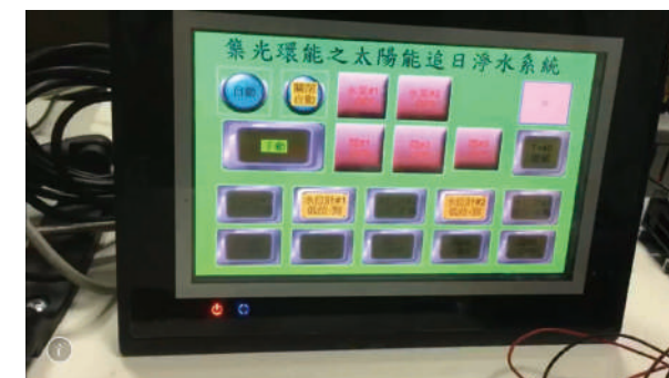
圖 10. 太陽能追日暨淨水流程電控系統之 HMI
