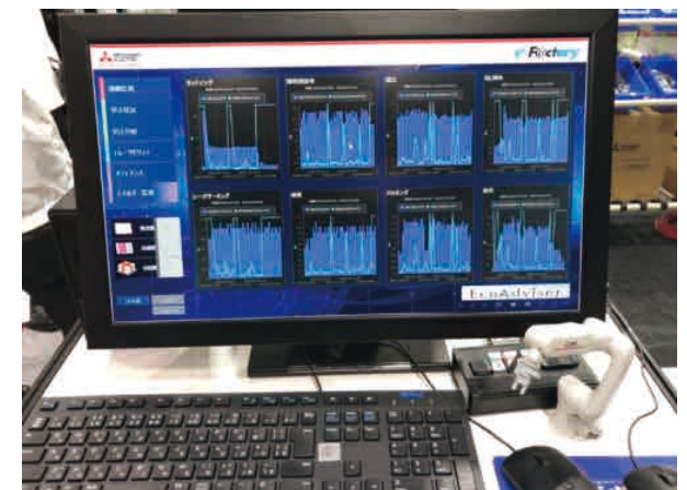
圖 13. 各機器手臂電流值監控
