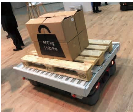
圖 20. 搬運 500KG AGV 在人群中移動
