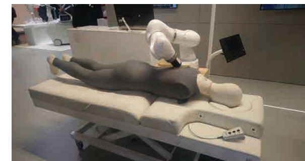
圖 26. KUKA 的安全機器人可代替復健師替中風患者進行物理復健 (2019 MEDICA)
