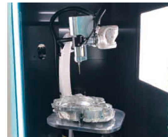
圖 25. KUKA 展現機器手臂搭配旋轉工作台進行銑削
