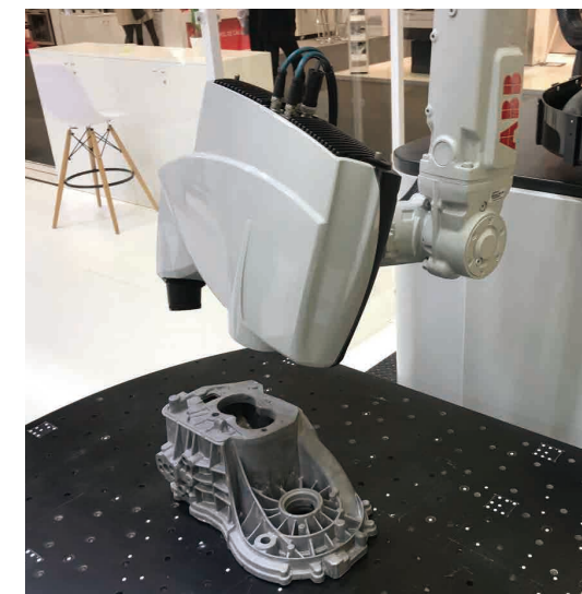
圖 2. 工業機器人自動化數位 3D 視覺及計量檢測
