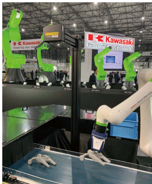
圖 3. FANUC 使用眼到手 (Eye-to-Hand) 相機並結合流水線作金屬工件夾取 (iRex 2019)
