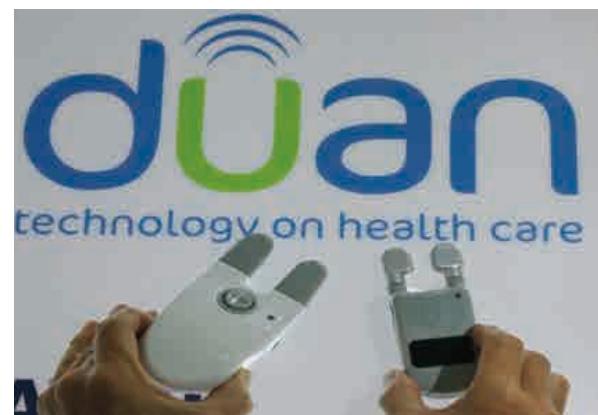
圖 14. 西班牙 duan 公司發表 Venoscopio IV Plus 血液採集器，可以使用 LED 突出顯示人體的外周靜脈，進而實現更精確的血液採集 (2019 MEDICA)
