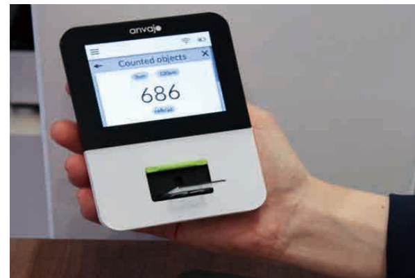
圖 13. 德國 Anvajo 公司展示診斷技術。其號稱如圖所示之流體分析儀是市場上最小，最方便的液體分析儀。它結合了功能齊全的光譜儀和高分辨率顯微鏡，可透過更準確的分析來改善診斷。Anvajo 的液體分析儀將微型光譜儀與數位顯微鏡相結合，目標樣品包括血液，尿液，精液、水 (2019 MEDICA)
