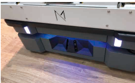
圖 22. MiR AGV 採用 2 個 CCD 來辨識人群走動
