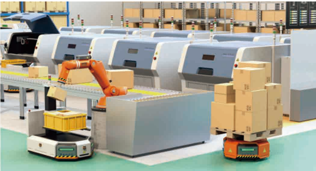
圖 2. 在這座假設性的物流中心或倉庫中，橘色機械手臂屬於工業機器人，2 輛低底盤車輛則為專業服務機器人。
