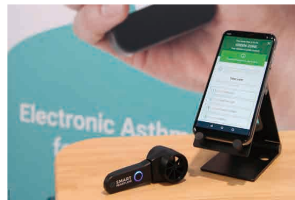
圖 8. 總部位於英國倫敦的 Smart PeakFlow 公司，為了主動控制哮喘而發明的裝置，只要將其放在智慧手機上，以口就管吹入設備，然後在手機螢幕上查看結果即可 (2019 MEDICA)
