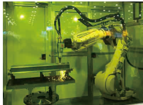
圖 23. FANUC 展現機器手臂進行雷射切割
