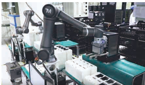
圖 2. 達明使用眼在手 (Eye-in-Hand) 相機定位 3C 產品零件
