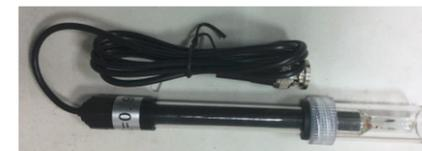
圖 7. 電導計 (第一代系統使用)
