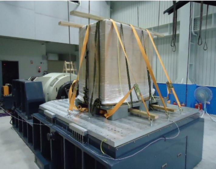
圖 2. 大型棧板包裝測試
