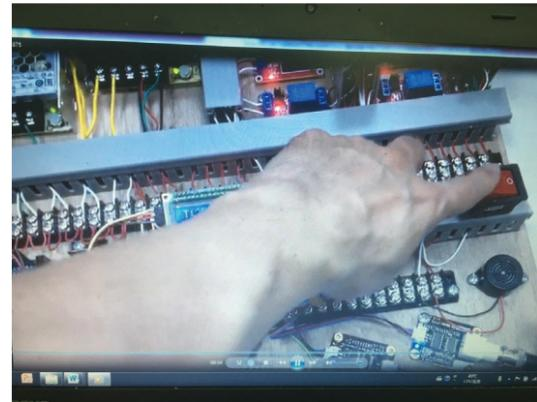
圖 15. 第一代純水品質監測暨警報系統之測試 (水質硬度、酸鹼值、溫度、導電率一起超標時，警報器響起且指示燈為紅色，此時，關閉警報器)
