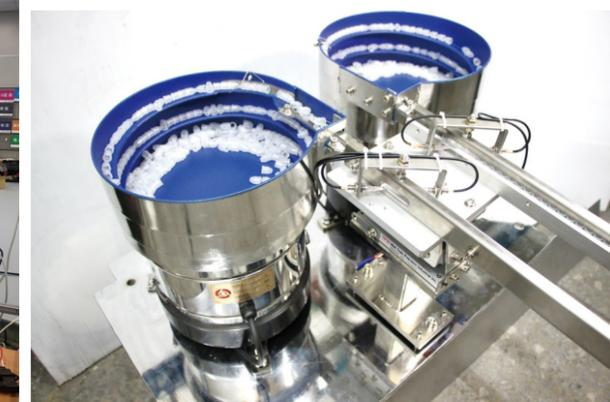
圖 3. 泛用供料單元 (左) 取代傳統震動盤 (右) 排料給料
