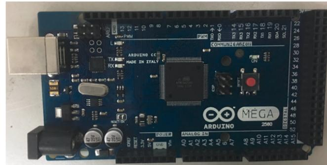
圖 3. Arduino Mega 2560 控制器
