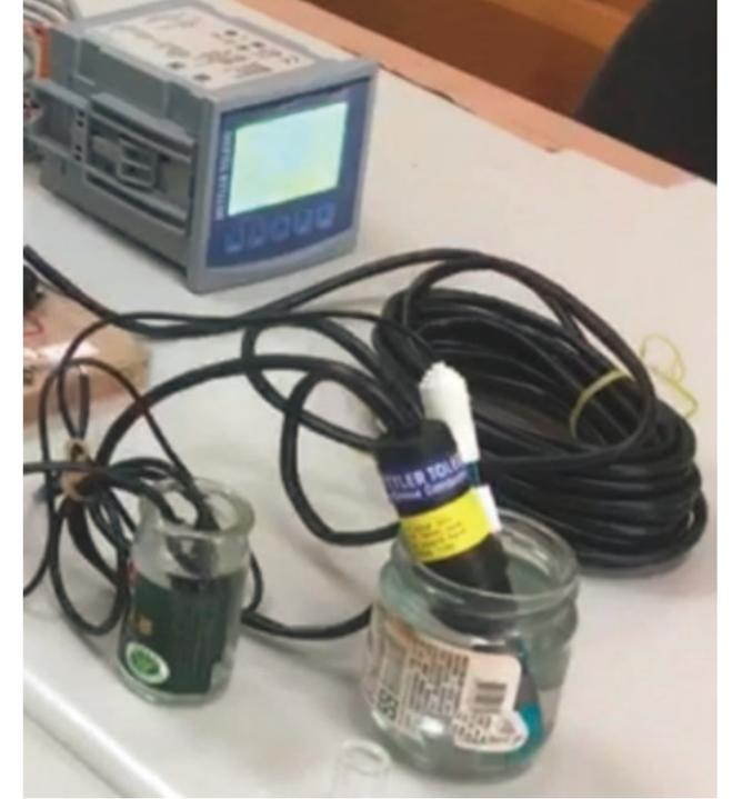
圖 17. 瑞士梅特勒托利多公司 (Mettler Toledo inc.) 之高精度電導計 (M-200 系列)
