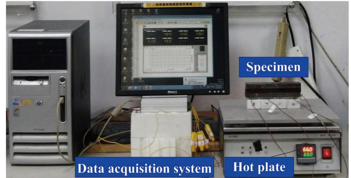
圖 6. 熱傳導係數之實際量測情形
