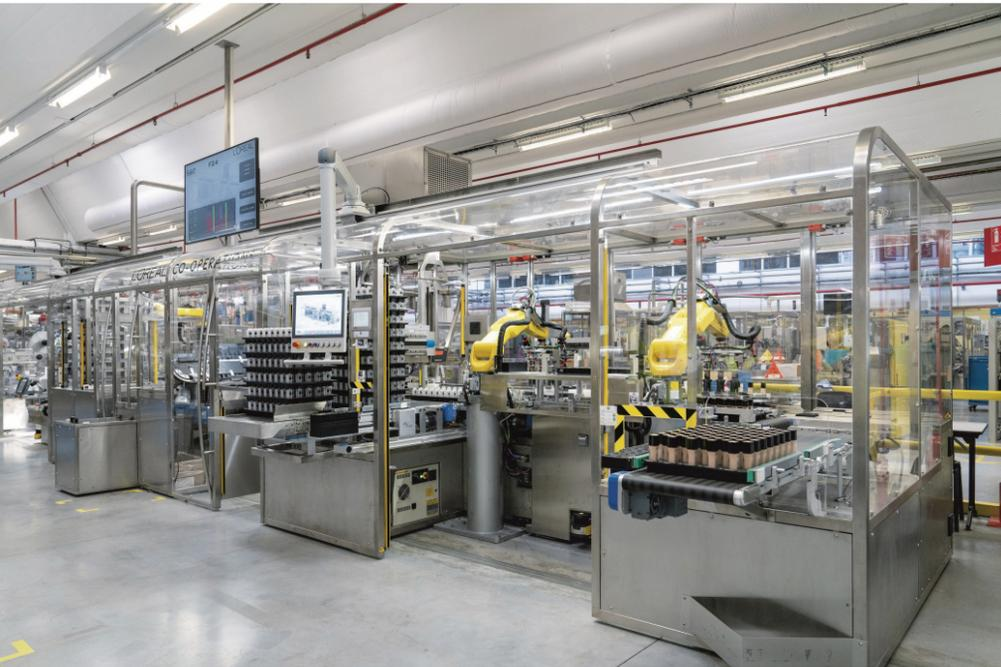
圖 5. 全新靈活的 Agile F24 生產線將先前五台獨立的設備功能整合於一體，可以優化物料流，提高產能
