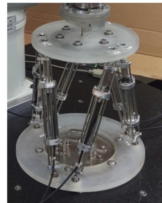
圖 3. 清華大學 / 雷衛台教授高效率六維運動量測裝置系統，藉由法人鏈結計畫協助，以補償校正協助機器設備克服幾何誤差與熱誤差，提升 10 倍量測精度
