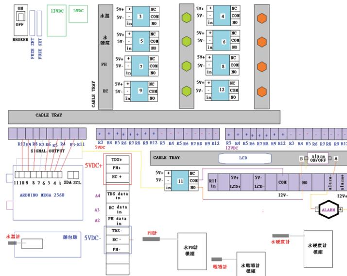
圖 4. 第一代純水品質監測暨警報系統架構示意圖
