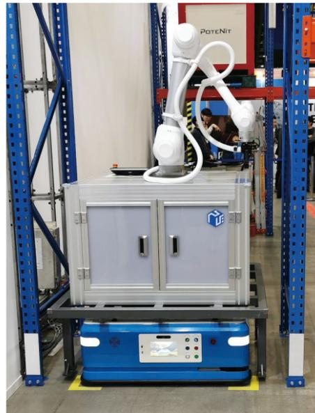
圖 4. AGV 頂升機器手臂工作站的應用 (2019 Robot World)
