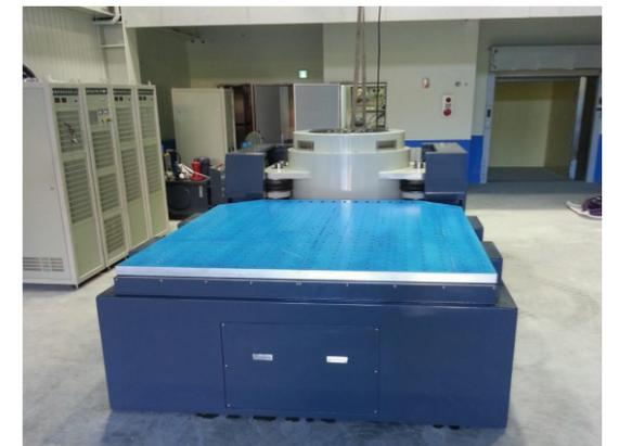
圖 1. 大型激震器整體全機實景
