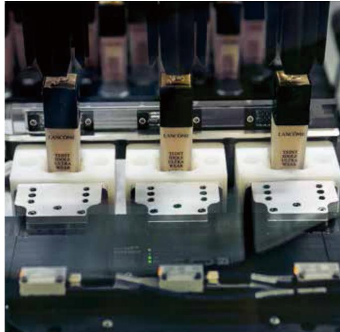
圖 4. 在灌裝過程開始之前，搬運機器人會將空的容器裝入卡盤（運輸托盤）中，並根據每個產品的具體規格將卡盤固定在 XTS 動子上
