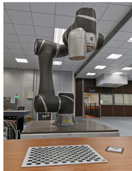
圖 6. Eye-in-Hand 的機器人座標辨識
