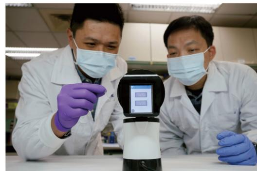
圖 5. 工研院研發的「iPMx 分子快速檢驗系統」重量僅 600 克，比目前的檢測儀重量足足輕巧 57 倍
