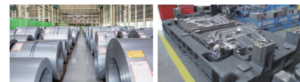
左圖：鋼捲，汽車車架，車殼的原始材料。右圖：各式各樣的沖壓模具，照片中為車門，車殼等鈹金件的沖壓模。
