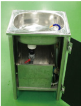
圖 7. 移除 PVB 异形冷卻水路沖刷設備之實體圖
