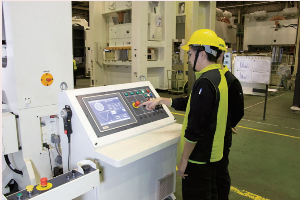
採用 Beckhoff 15 吋觸控面板，輕鬆操控沖床設定。
