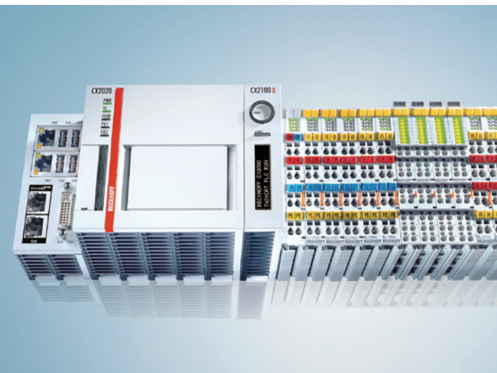
倍福 EPC 可直接整合 Safety 與 I/O 接口，並可擴展模組化選項。 Beckhoff Embedded PC can integrate Safety and I/O interface, and offer modular extension options.
