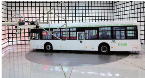
圖 3. 車輛中心執行整車輻射干擾測試實務案例
