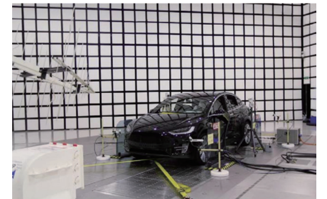
圖 14. 整車輻射干擾量測實驗車測試實務案例
