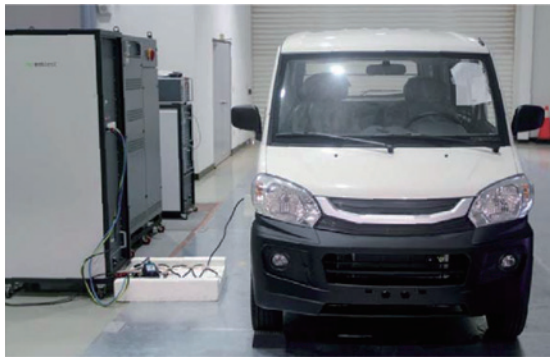
圖 16. 整車傳導耐受試驗實車測試實務案例
