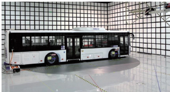
圖 5. 車輛中心執行電動大巴充電模式輻射干擾測試實務案例
