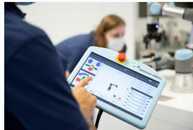
圖2.UR示教器，直覺的操作面板讓作業員能快速上手
