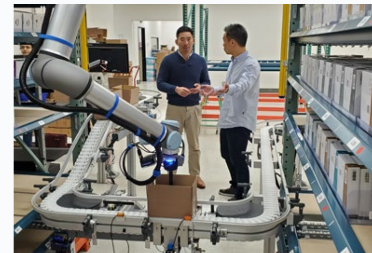
圖3.美國DCL物流公司導入UR10e機器人進行物件取放及裝箱作業，業務量成長30%，24小時全天候運作
