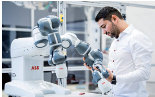
圖1. 協作型機器人在設定的工作區域內，可以安全的與人類互動，應用於工業場景時，在作業員與機器人之間無須設置安全圍籬欄
