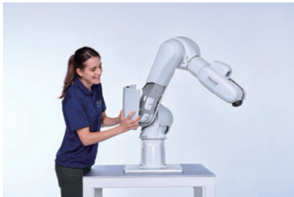
圖3. 工業機器人加裝「安全皮膚」，兼備人機協作安全與生產效益(資料來源：原見精機)
