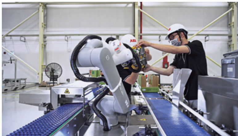
圖4. 現行工廠沒有空間放置傳統工業機器人，ABB建議使用具備5公斤負載的GoFa™協作機器人
