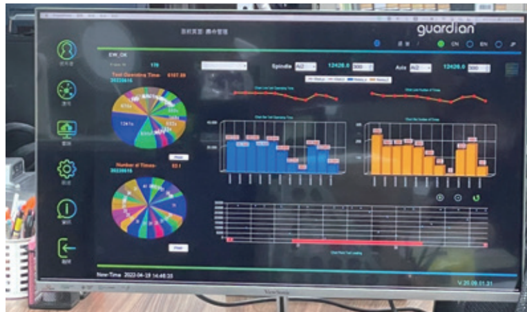
圖2. 歐權科技導入智能刀具系統建置追蹤平台，利用AI深度學習運算，建立刀具壽命診斷與預測模型，提升產品的精度與良率
