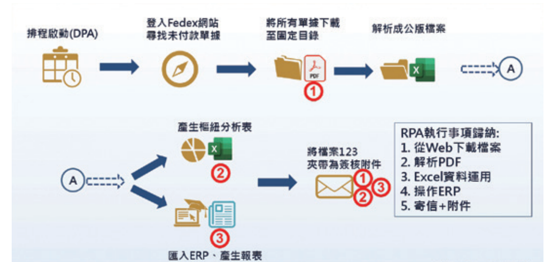
圖2. 貨運業應用RPA進行帳單處理自動化作業流程
