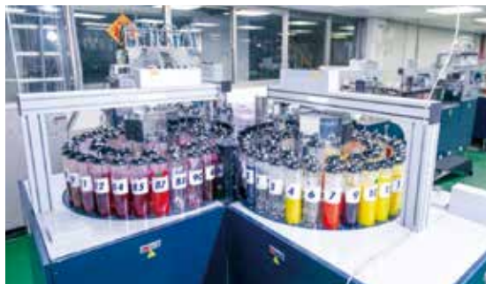
圖3.東欣實業建置智慧對色平台，整合辨色儀與ERP系統配方數據，利用AI深度學習技術，提供精準的打色配方，進而將「一次對色率」從原本40%提升到60.5%
