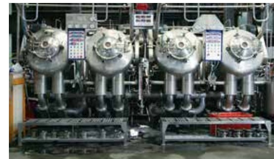
圖4.東欣實業建置智慧染機中央控制系統，在染缸上安裝監控感測器，透過數據監控，掌握染缸生產狀況，降低重修率以及改善異常，提高品質與生產效率
