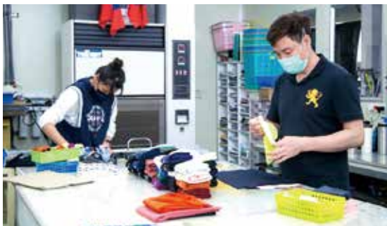
圖2.東欣實業建置智慧對色平台，整合辨色儀與ERP系統配方數據，利用AI深度學習技術，提供精準的打色配方，進而將「一次對色率」從原本40%提升到60.5%
