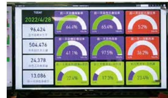
圖5.東欣實業建置智慧染機中央控制系統，在染缸上安裝監控感測器，透過數據監控，掌握染缸生產狀況，降低重修率以及改善異常，提高品質與生產效率
