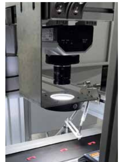
圖2.導軌塊缺陷檢測系統
