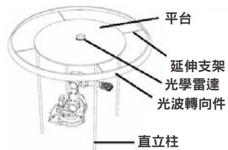
圖5.支撐架示意圖
