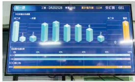
圖5.華城電機透過導入自動生產排程、可視化整合電子看板以及整合物料管理系統蒐集數據，整合戰情中心呈現，以掌握生產進度
