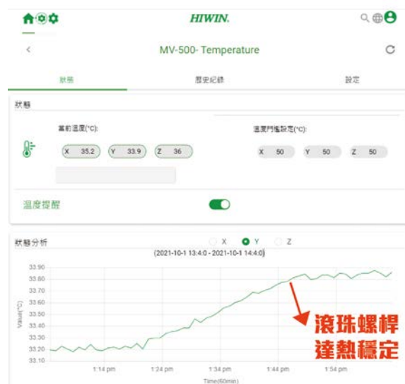
暖機時間與螺桿溫度變化圖
