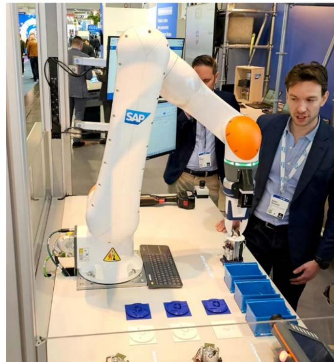
圖 6. 機器人結合機器視覺進行瑕疵檢測，並以即時投影協助現場作業人員
