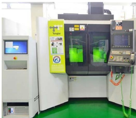
圖 2. 五軸加減複合機
