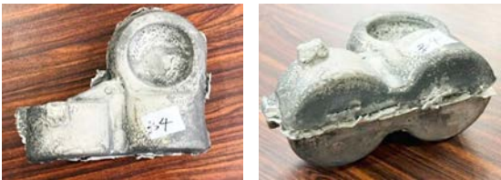
圖 13. 噴塗不均勻導致卡在鍛模的鍛件
