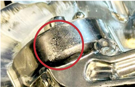
圖 14. 石墨堆積鍛件表面品質不佳
