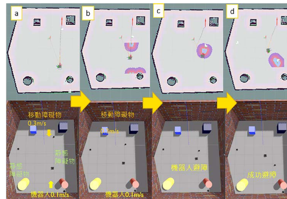
圖 6. 機器人加入速度障礙物層方法的避障過程，上方為可視化工具畫面，下方為模擬環境畫面
