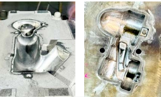
圖 4. 汽車避震器上座鍛造模
