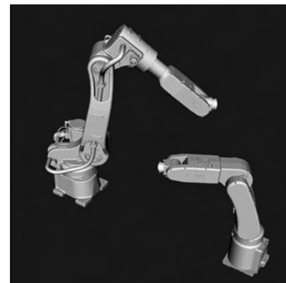
圖 10. 在 ROS2 中進行雙臂機器人系統自我避障運動的模擬及視覺化。
