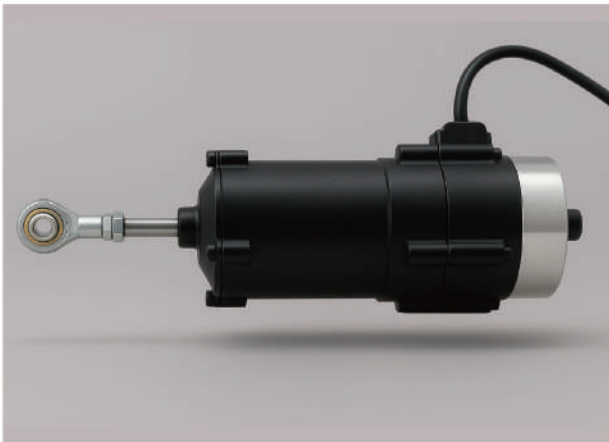
上圖為全球傳動的 IPRS 10型 線性致動器，採用反向式行星滾柱螺桿之系列模組可搭配伺服馬達或直驅電機構成關節驅動單元，已在多型人形機器人樣機中驗證。
